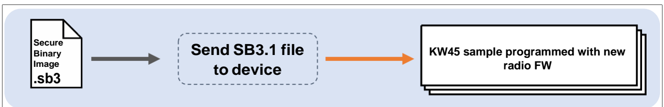
图 14. 在此步中, 生成的*.sb3 文件被烧写到 KW45 中
